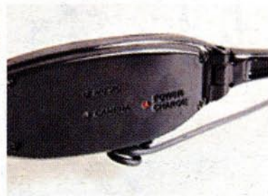
■右邊鏡架內側有三個指示燈，可顯示目前使用狀態：電源/音樂/攝錄。
