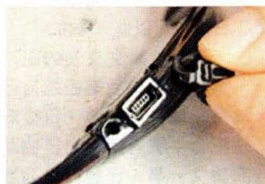
■在左側眼鏡腳底部有一個連接USB的插槽，用來充電和下載音樂資料。
